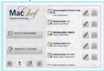
I comandi per gli abbattitori della linea *MacChef* sono effettuati tramite un controllo **touch screen** da 7". Tramite touch screen si ha la possibilità di salvare le varie configurazioni in funzione degli alimenti da abbattere o surgelare. Tramite touch screen è possibile programmare un ciclo di preraffreddamento in modo da avere l'abbattitore pronto all'occorrenza. La programmazione è elettronica a tempo o a spillone. La sonda a spillone è riscaldata per una più facile estrazione.
