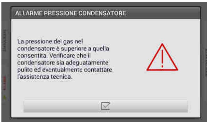
Come da immagine sopra, se la pressione del gas nel condensatore, dovesse superare il valore consentito, potrebbe comparire la comunicazione sopra.
