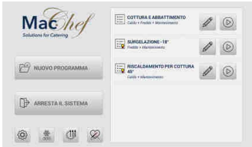
La videata sopra, dimostra tre programmi salvati con la specifica del nome le funzioni utilizzate e le temperature di lavoro. Premendo il tasto a destra di ogni programma (la freccia) questo inizierà la lavorazione.
